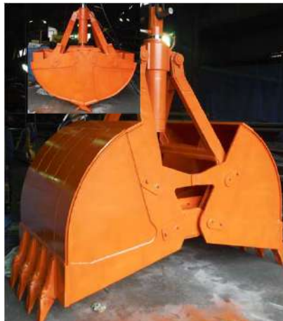
クラムセルバケット 基礎工事、深掘掘削に
