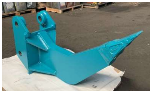
ミキシングバケット 地盤改良、固化剤攪拌に
